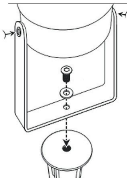
2. Benutzen Sie dieselbe Sechskantschraube und dieselbe Unterlegscheibe zur Befestigung der Gelenkhalterung am Erdspeiß. Positionieren Sie dafür die beiden Löcher übereinander und drehen Sie die Schraube ausreichend fest, damit der Strahler nicht wackelt.
