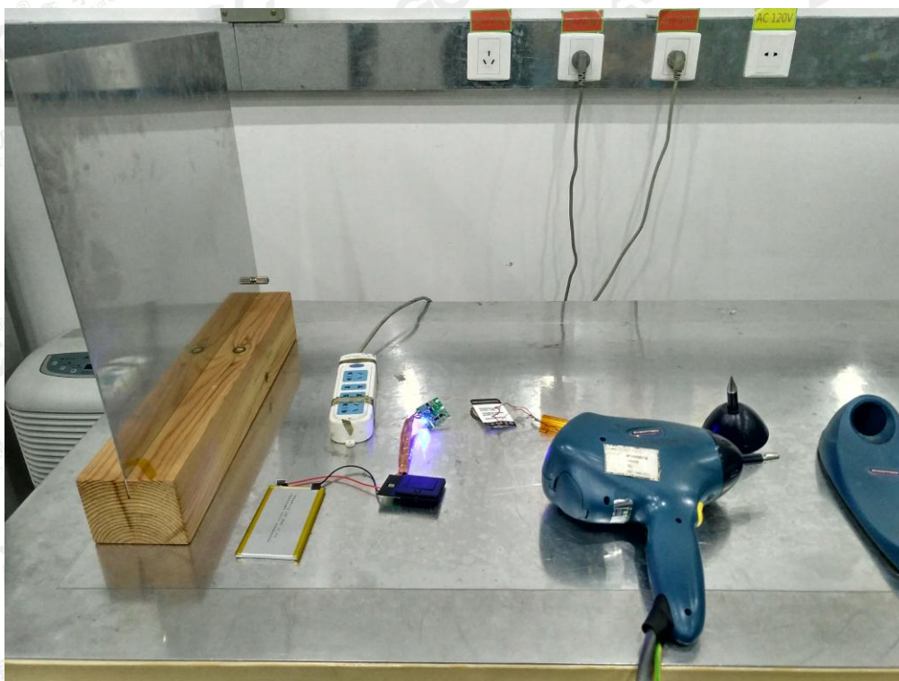
EN 61000-4-2 ESD TEST SETUP
