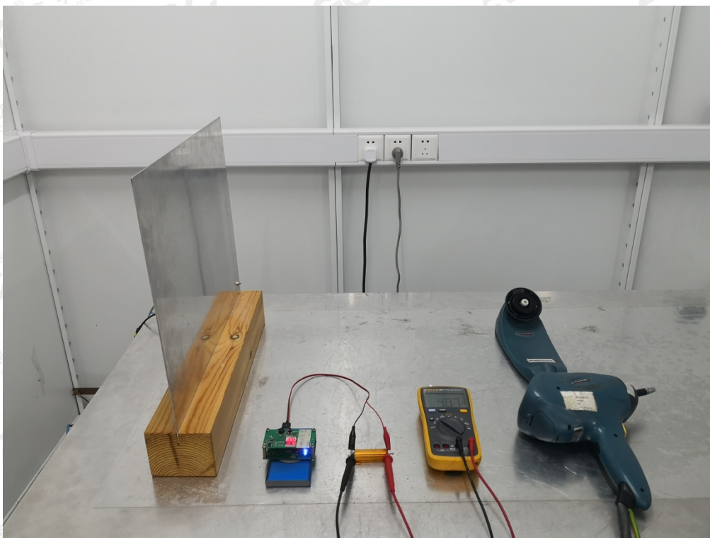
EN 61000-4-2 ESD TEST SETUP
