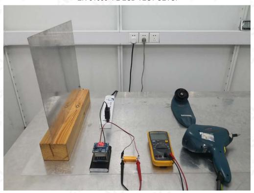
EN61000-3-3 VOLTAGE FLUCTUATION / FLICKER TEST SETUP
