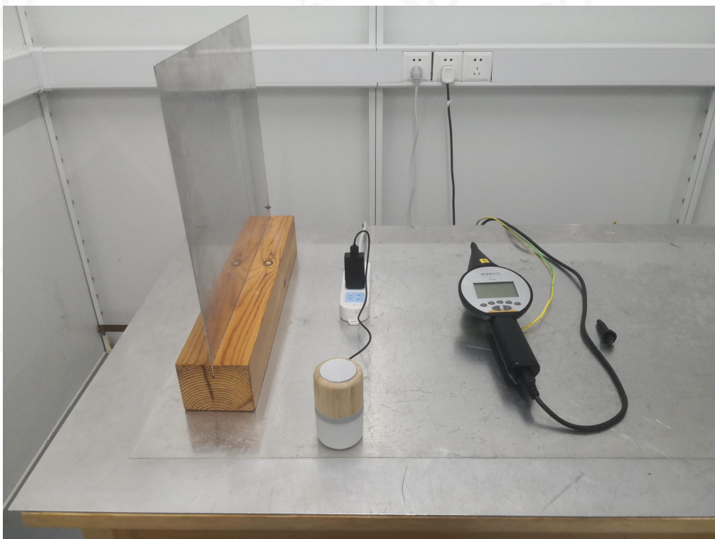
EN 61000-4-2 ESD TEST SETUP
