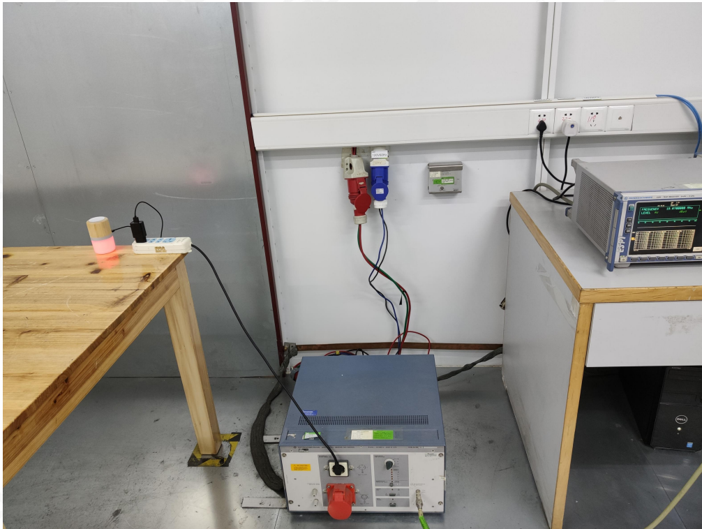
EN 61000-4-2 ESD TEST SETUP
